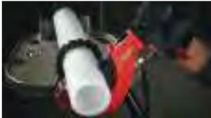
Se adapta para cortar PEX de 3" (76mm)
